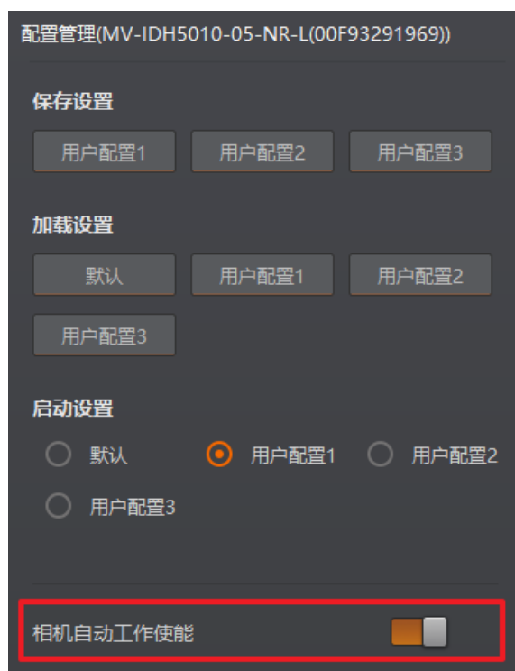
图3-42 相机自动工作使能
