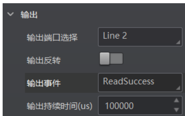
图3-19 输出参数设置
