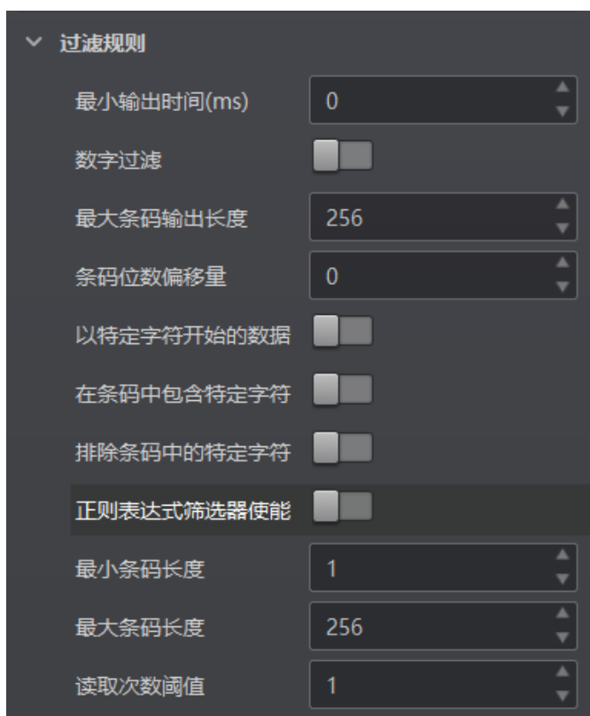
图3-21 过滤规则参数
