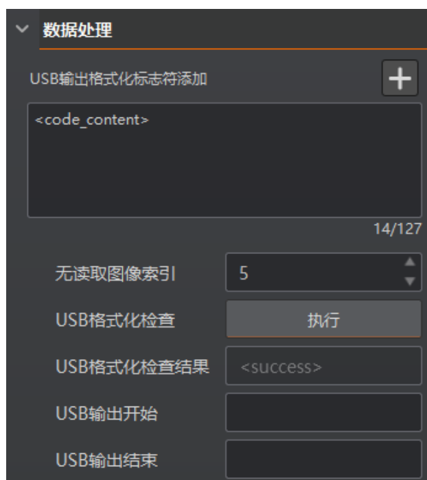
图3-24 USB 协议的数据处理
