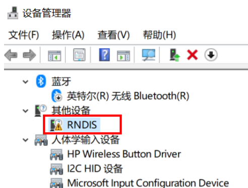
图2-6 设备驱动安装失败
