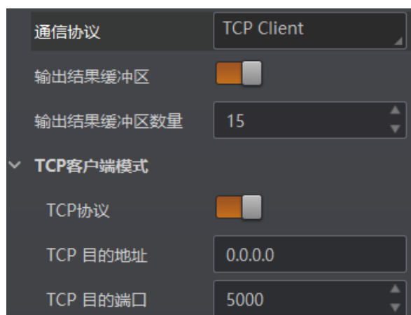
图3-29 TCP Client 方式
