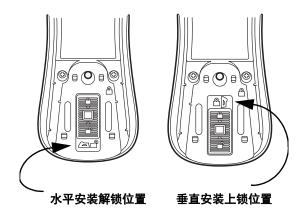
借助适合安装表面材料的 3 个螺钉牢固固定基座。
